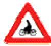
A25 Passage pour conducteurs de bicyclettes et de cyclomoteurs à deux roues, ou endroit où ces conducteurs débouchent d'une piste cyclable sur la chaussée.
