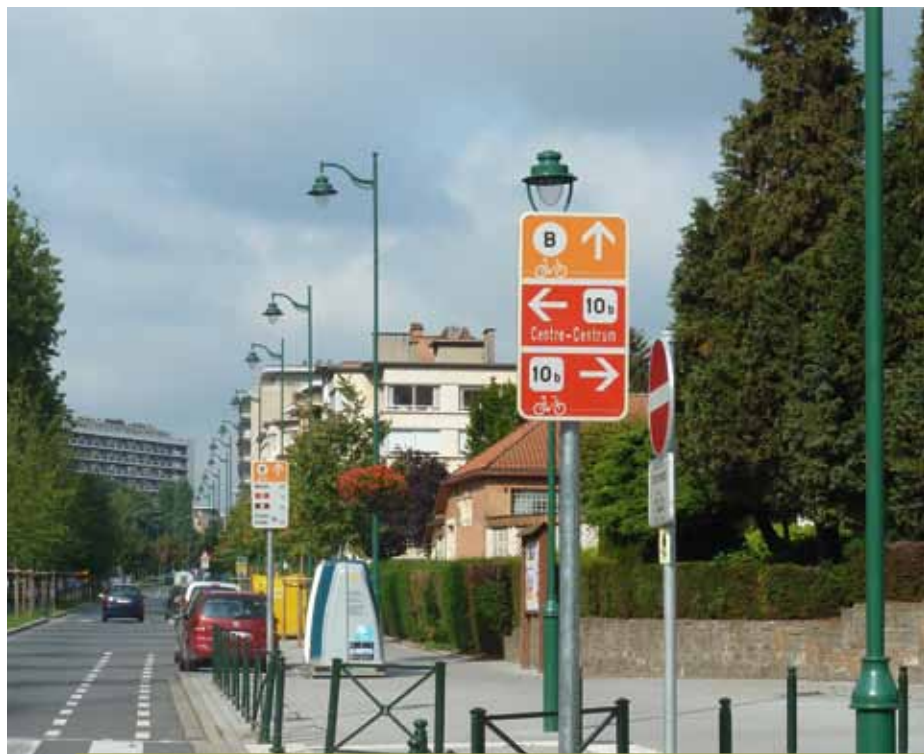
Kruising van fietsroutes: het bord op de voorgrond kondigt het kruispunt aan en toont de fietser de verschillende richtingen. Het bord op de achtergrond, na het kruispunt, bevestigt de gekozen
