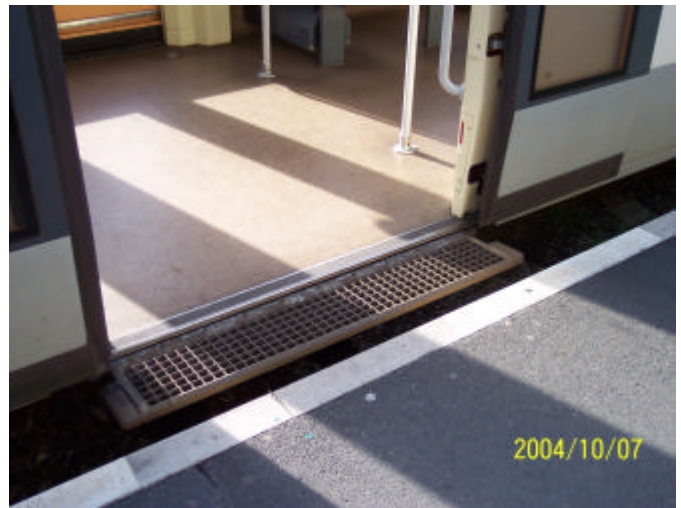
L'accessibilité du tram-train aux personnes moins valides est assurée par un plancher bas, à hauteur de quai
